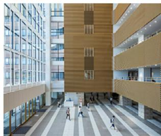
頂部に設けた自然換気窓により、「風の道」として機能するエントランスホール
