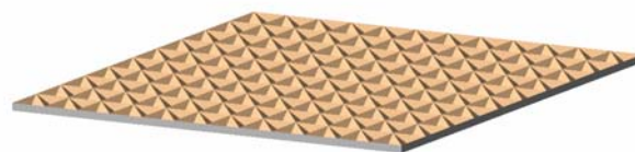
図 3 3枚鏡タイプの再帰反射パネル
