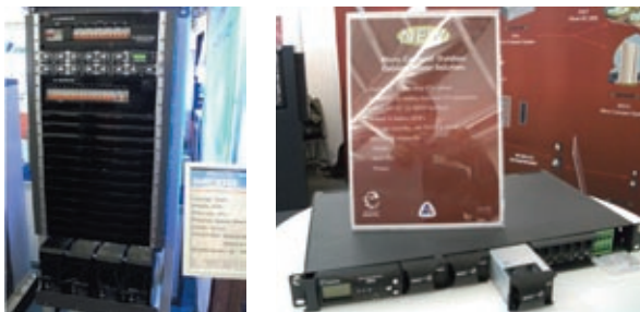
(a) 48 V, 280 A 出力整流装置 入力：単相200 V 効率：94% (Dongah Elecomm 社) (b) マイクロコンパクト整流器 出力：48 V, 13 A (800 W) × 3 (Enatel 社)
