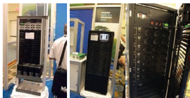
(a) DC 54 V, 20 kW 出力整流装置 (-54V, 37A 出力ユニットが11台搭載) (b) DC 300V, 60 kW 出力整流装置 (300V, 33A ユニットが7台搭載)
