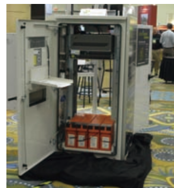
図10 太陽光発電用DC-DCコンバータを搭載したキャビネット(Eltek Valere社)
