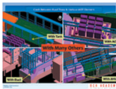
図4 BIMデータのクラッシュ箇所 3)
