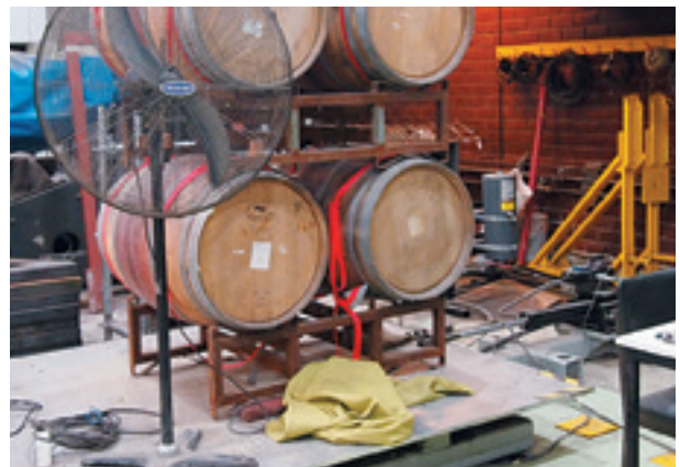
写真26 ワイン樽用ラックの加振実験
