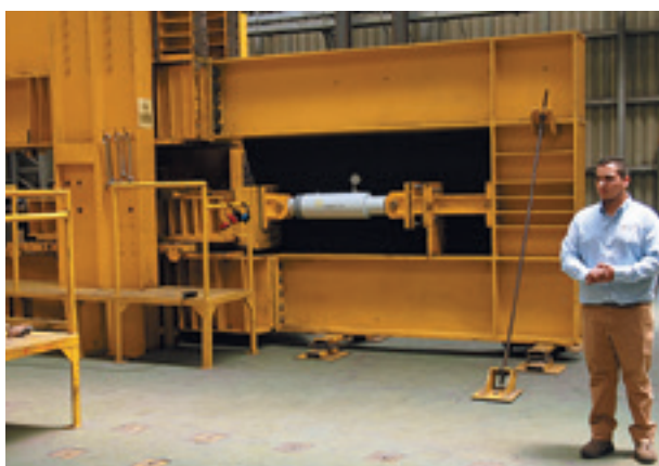
写真28 制振ダンパー試験機
