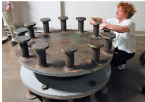
写真7 建物に使われている実物の積層ゴム支承
