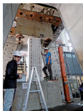
写真4 RC柱加力中のMATS
