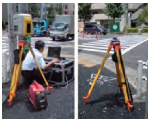
図11 3D スキャンの実施風景（左が 3D スキャナ本体）
