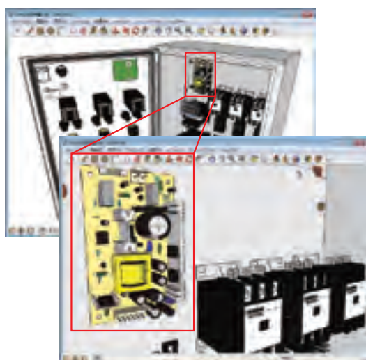
図7 SketchUpの詳細部品のモデリング例
