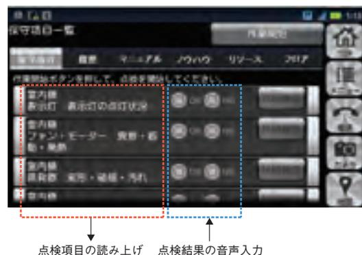
図1 点検結果の音声入力イメージ<sup>7)</sup>
