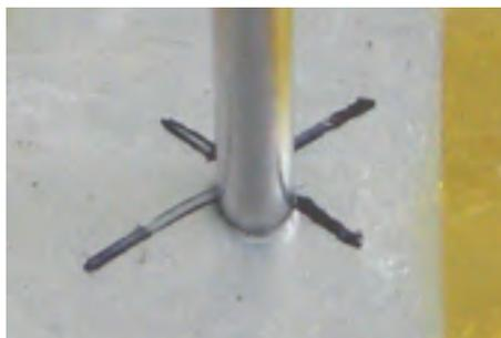
図2 200mm/秒の釘刺し後の電池表面
