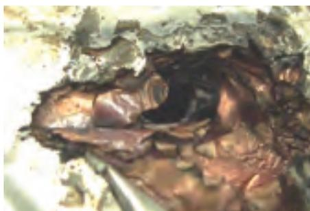
図4 20mm/秒の釘刺し後の電池表面
