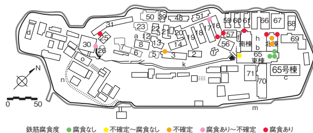
図6 鉄筋腐食調査結果 5,8)
