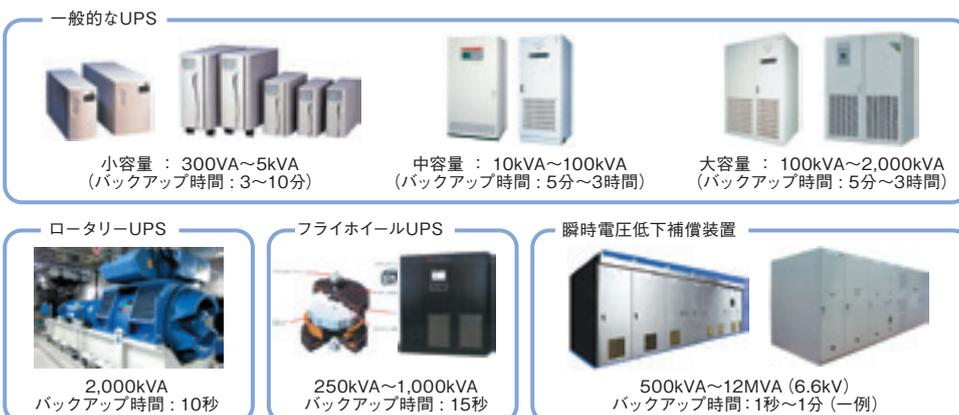
図3 各種無停電電源装置（UPS）
