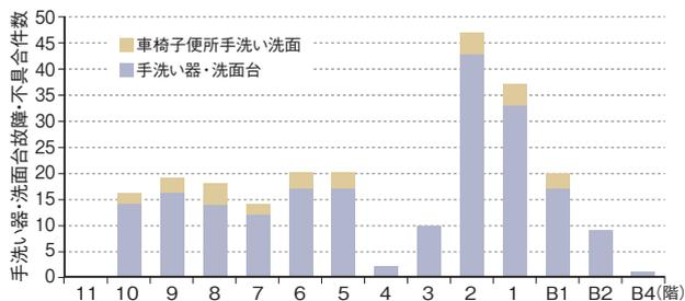
図6 病院棟各階の手洗い器・洗面台の故障・不具合件数
