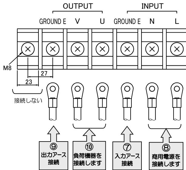
端子台に接続する負荷機器と、「§ 6.4.2」で出力コンセントに接続する負荷機器の容量合計がUPS出力容量を超えないようにしてください。UPS出力容量は「§ 12.4 仕様」で確認してください。
