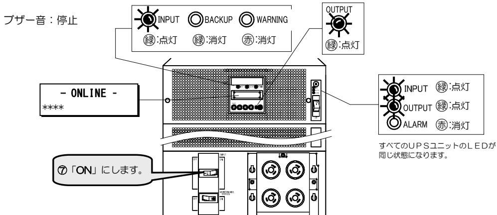
UPSが正常に機能している場合は、手順⑥、⑦に示すブザー音、LCD表示、LED状態になります。
