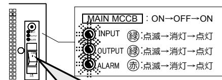
**MAIN MCCB**を「OFF」にして、LEDの消灯を確認した後、再度「ON」にします。
