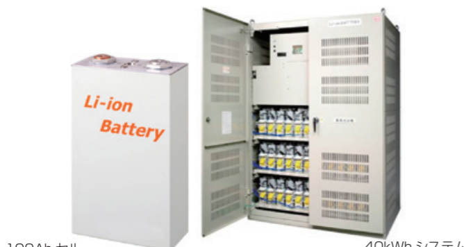
100Ah セル 40kWh システム (107 直列) データセンター向けバックアップタイプリチウムイオン蓄電池システムの例 (500A - 10 分保持システム)
